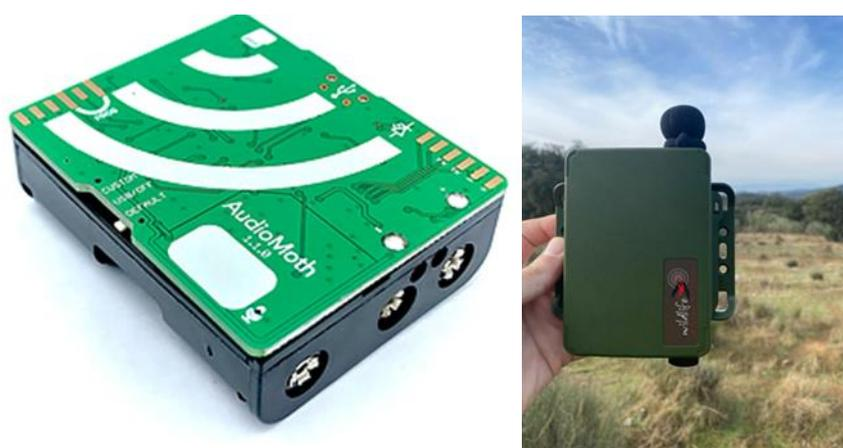
**Figura 32.** Grabadoras de sonidos utilizadas durante el proyecto Zorzales. AudioMoth (izquierda) y Song Meter Mini (derecha).
